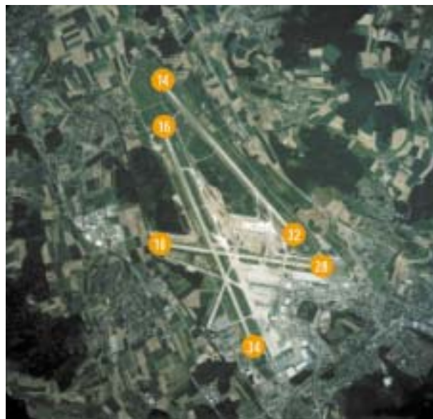
Abbildung 3: Pistensystem des Flughafens Zürich-Kloten (Orthophoto)
